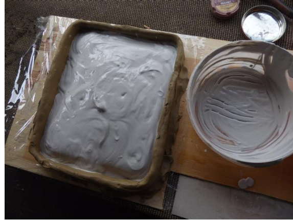
Obtención del molde en escayola
